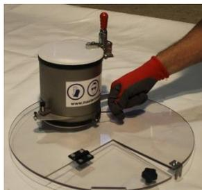
2. Colocar el dosificador y apretar los tornillos de forma escalonada. Uno y después otro, colocando el dosificador recto.
