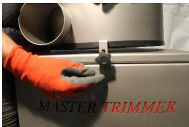
3. Colocar el contenedor principal encima de la rejilla y fijarlo con los tornillos proporcionados.
