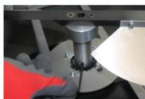
**1 Aflojar el tornillo bloqueador del eje**
