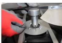
**3 volver a apretar el tornillo bloqueador del eje**
