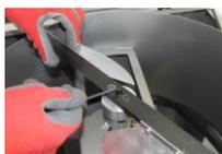
**2 Aflojar el tornillo central del eje**
